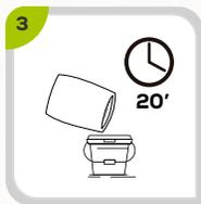
3 Prepare una cantidad de adhesivo suficiente como para veinte minutos 20' de trabajo y déjela reposar por 10 minutos antes de iniciar su aplicación. Utilice agua limpia y recipientes libres de impurezas. No combine una mezcla recién hecha con otra ya reposada, pues esto reducirá su adherencia.
