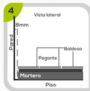
4 Se debe dejar una dilatación perimetral de 8mm entre el borde externo de la baldosa con respecto a muros y columnas. Los pisos se deben instalar en secciones de máximo 25 m<sup>2</sup> (este valor puede variar de acuerdo a las condiciones del proyecto), con una dilatación de 8mm entre ellas. Estos espacios deben incluir al mortero de nivelación y continuar hasta la placa base, si el ambiente tiene juntas estructurales debe respetarlas.
