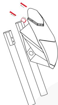
Posteriormente retira el tornillo goloso de la parte superior del tacómetro e inserta los bujes de aluminio.
