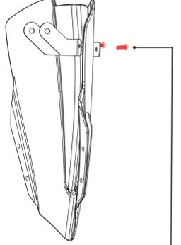
Introduce los tornillos BOTTON (5 X 15) en la parte frontal atravesando la PLATINA FRONTAL, CÚPULA, SOPORTE CELULAR y darle apriete final por la parte de atrás de la cúpula con las tuercas (M5).
