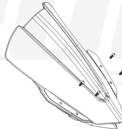
Introduzca los tornillos BOTTON 5 X 15 en la cúpula atravesando el herraje y proceda a apretar con las tuercas las tuercas M5 hasta el final.
