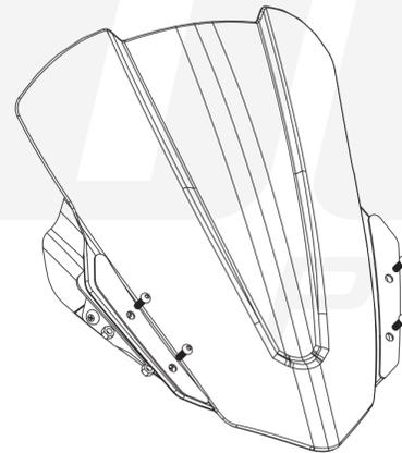
Introduzca los tornillos BOTTON (5 X 15) en la cúpula atravesando el herraje y proceda a apretar con las tuercas las tuercas (M5) hasta el final.
