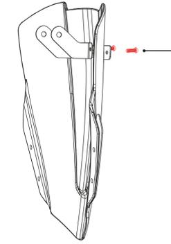
Introduce los tornillos BOTTON (5 X 15) en la parte frontal atravesando la PLATINA FRONTAL, CÚPULA, SOPORTE CELULAR y darle apriete final por la parte de atrás de la cúpula con las tuercas (M5).
