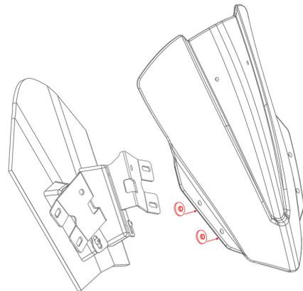
Instala los cauchos en cada perforación de la cúpula.
