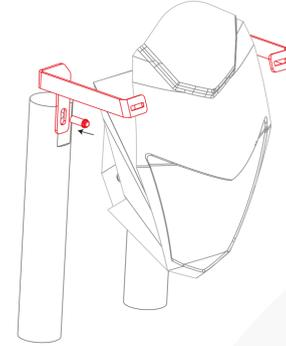
Posicionar los herrajes #1 en las barras e insertar los tornillos anteriormente retirados.
