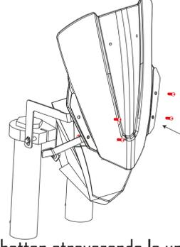
Inserta los tornillos botton atravezando la upula y herraje # 2, luego proceda a darle el ajuste final a los tornillos con las tuerca M5 .
