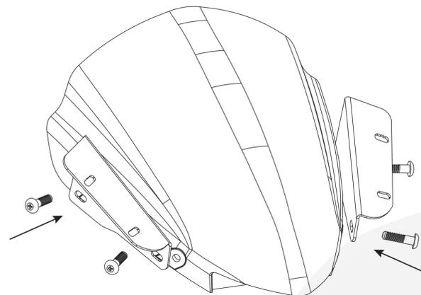
Instale los cauchos en las respectivas perforaciones de la cúpula original , luego procedemos a instalar el herraje con los tornillos anteriormente retirados en el PASO 1.
