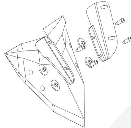
Instale los cauchos en las respectivas perforaciones de la cupula original , luego procedemos a instalar el herraje con los tornillos anteriormente retirados en el PASO 1.
