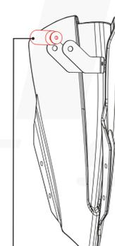
Instala el tubo de aluminio con cauchos a ambos lados del tubo, luego lo ubicamos entre los SOPORTE CELULAR.
