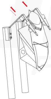
Inserta el tornillo goloso proporcionado en el kit de la cúpula, atravezando la platina y el buje.
