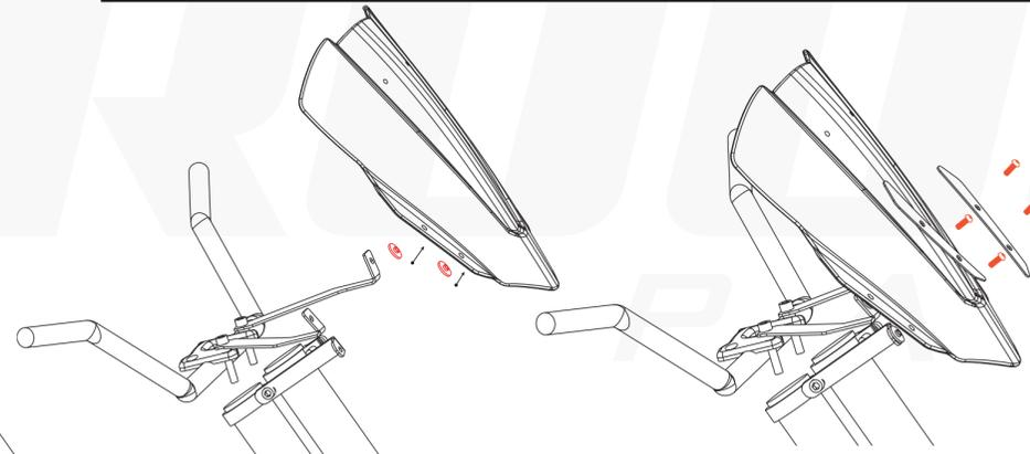
Inserta los cauchos en las perforaciones de la cúpula, posiciona la cúpula en los herrajes y darle el ajuste final con los tornillos button.
