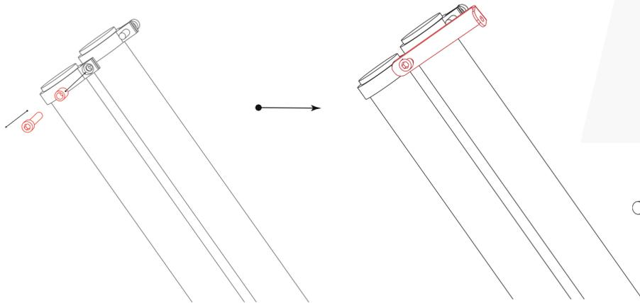
Retire el tornillo de las barras e inserte el buje largo; Posteriormente posiciona el herraje e introduce el tornillo bristol 8x50.
