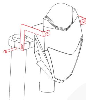
Posicionar los herrajes #1 en las barras e insertar los tornillos anteriormente retirados.
