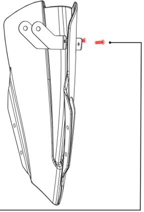
Introduce los tornillos BOTTON (5 X 15) en la parte frontal atravesando la PLATINA FRONTAL, CÚPULA, SOPORTE CELULAR y darle apriete final por la parte de atrás de la cúpula con las tuercas (M5).
