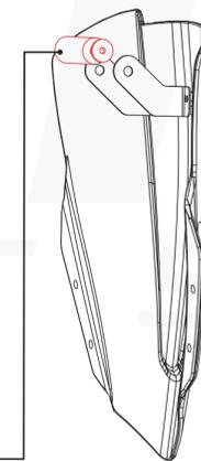
Instala el tubo de aluminio con cauchos a ambos lados del tubo, luego lo ubicamos entre los SOPORTE CELULAR.
