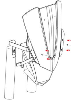
Inserta los tornillos botton atravezando la upula y herraje # 2, luego proceda a darle el ajuste final a los tornillos con las tuerca M5 .
