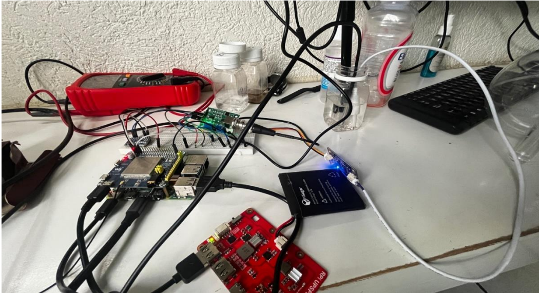
Ilustración 28.- Prueba de los sensores con agua
