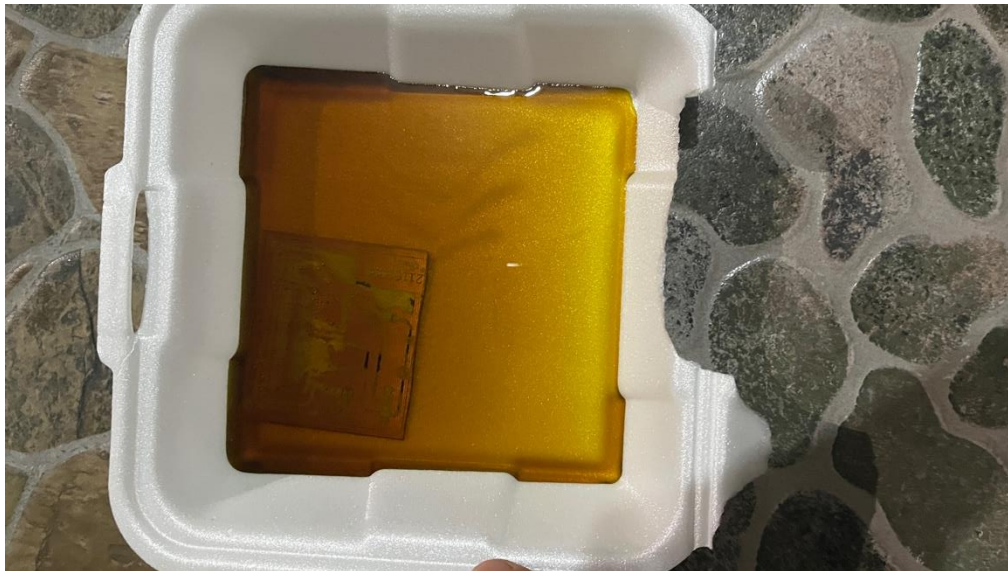
Ilustración 35.- Baquelita en Cloruro férrico
